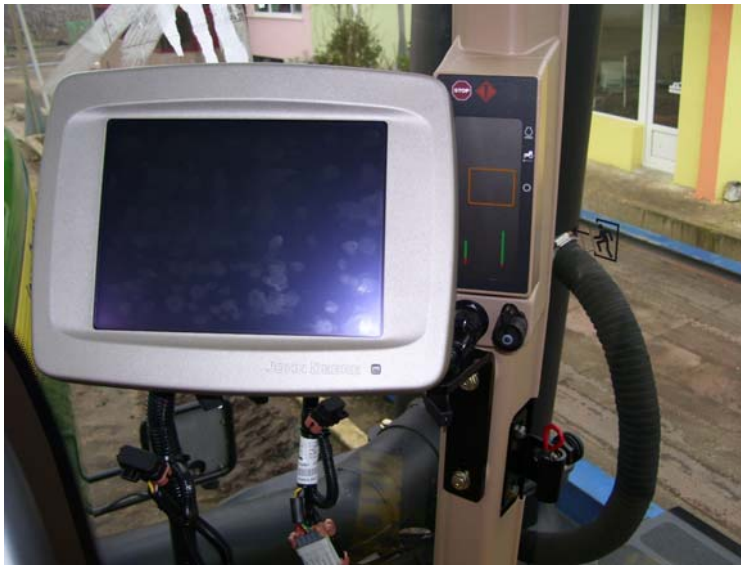
Фигура 1. Компютърна система за диагностика и контрол на работата на трактор JOHN DEERE 9630T
